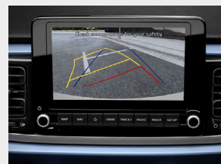
Retrocamera con linee guida dinamiche
