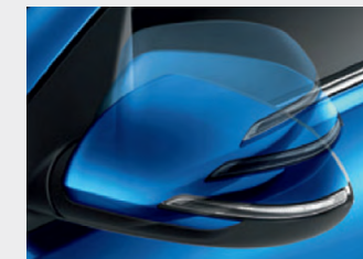
Retrovisori esterni con indicatori di direzione integrati a LED
