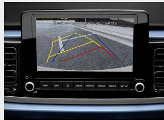
Retrocamera con linee guida dinamiche
