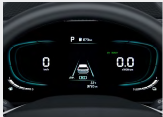
Cluster a cristalli liquidi con display LCD da 4,2"
